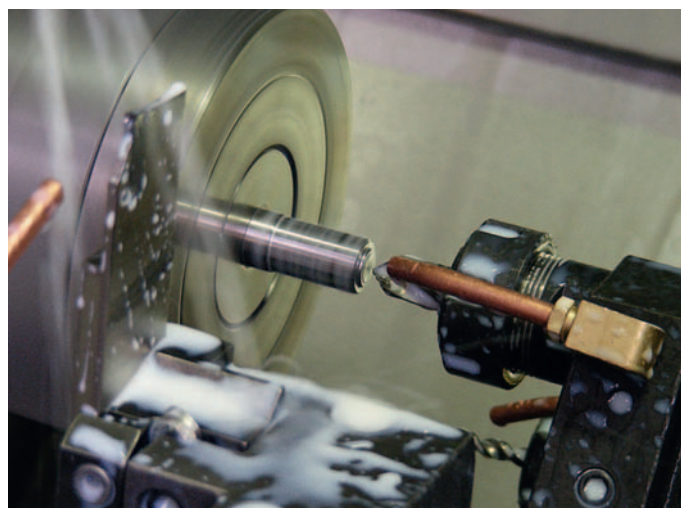
Hochpräzise und produktive Fertigung ab der Stange. Die «Miyano ABX-51 SY» kann dank ihrer Prozesssicherheit und durchdachtem Automatisierungskonzept sicher mannlos produzieren. (Bilder: Böhm)
