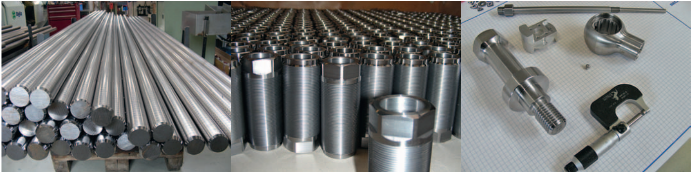
Präzise, komplex und schwierig zu zerspanen: typisches Teilespektrum bei der R. Arnold AG, das in den meisten Fällen direkt von der Stange gefertigt wird.
