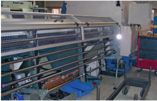
Automatisierungskonzept: Ab der Stange werden die Werkstücke gefertigt und von dem spänegeschützten Teilefänger dem Förderband zugeführt.
